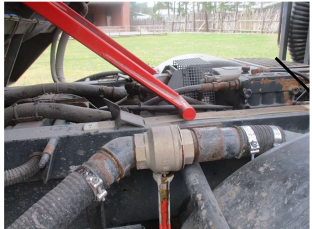
Kuva 1. Huoltotuen vapauskyynsi esti huoltotukea asettumasta paikoilleen.
