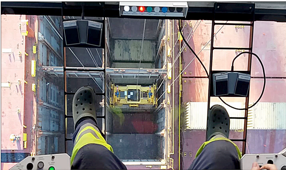
Kuva 1. Nosturin tarttujan ja ohjaamon ohjauspaneelin merkkivalot. Punainen valo tarkoittaa, että lukot ovat kiinni. Kuvan alus ja nosturi, eivät liity tapaukseen.
