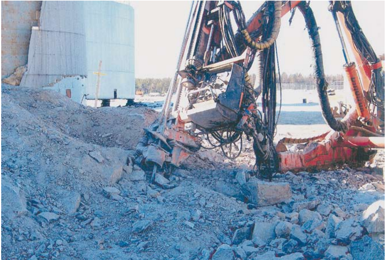
Kuva 2. Porausvaunu räjähdysen jälkeen.
