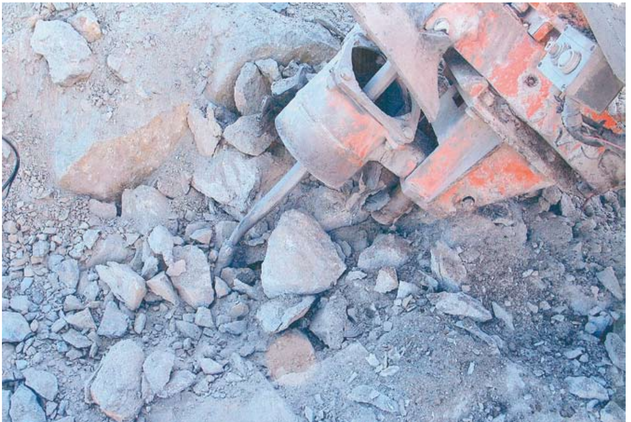
Kuva 3. Osasuurennos kuvasta 2. Poranterä räjähdysen jälkeen.
