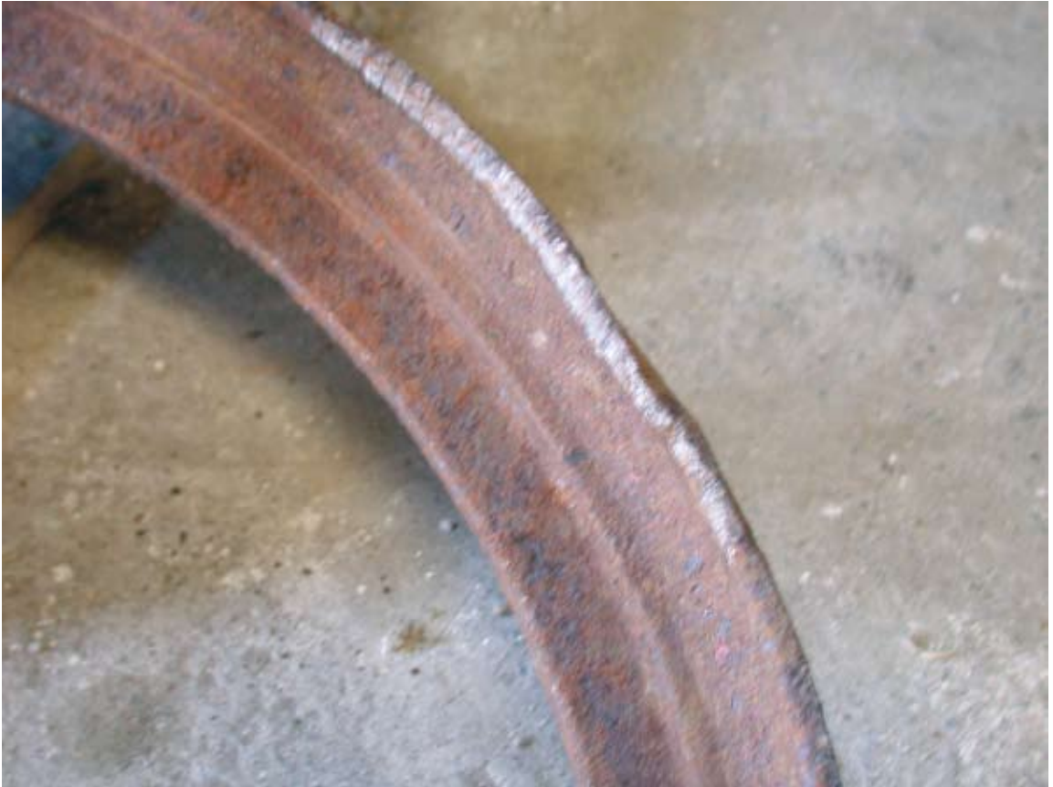
Kuva 3. Uloimmassa lukkovanteessa oli muotovirhe.
