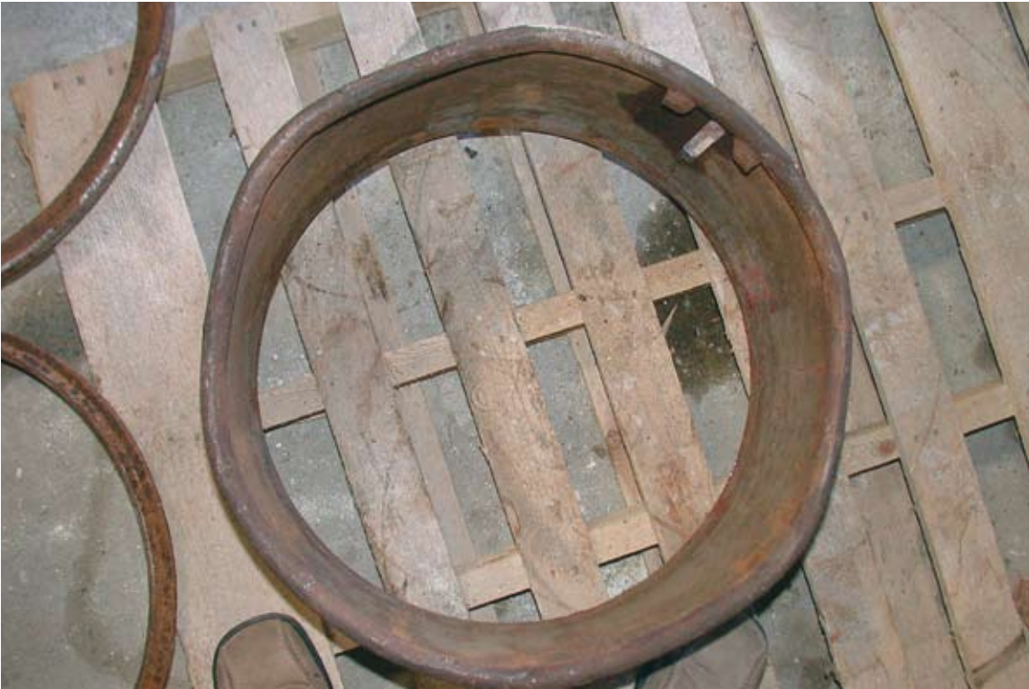
Kuva 1. Renkaan varsinainen vanne oli saanut käytössä erittäin voimakkaita iskuja, joista johtuen siinä oli neljä suurta muodonmuutosaluetta
