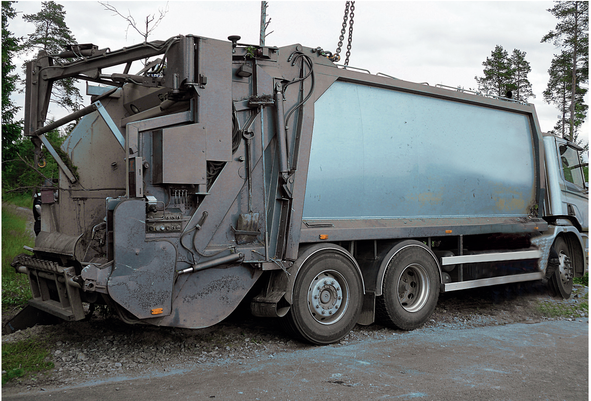
Kuva 2. Jätepakkaajan paino vaikuttaa merkittävästi kolmiakselisen kuorma-auton painopisteeseen ja hallittavuuteen, etenkin kun teli on ylhäällä.
