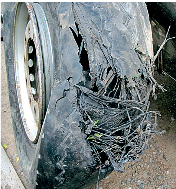
Kuva 1. Eturenkaan rakenteen pettäminen kesken ajon oli välittömänä riskitekijänä yhdessä onnettomuudessa.
