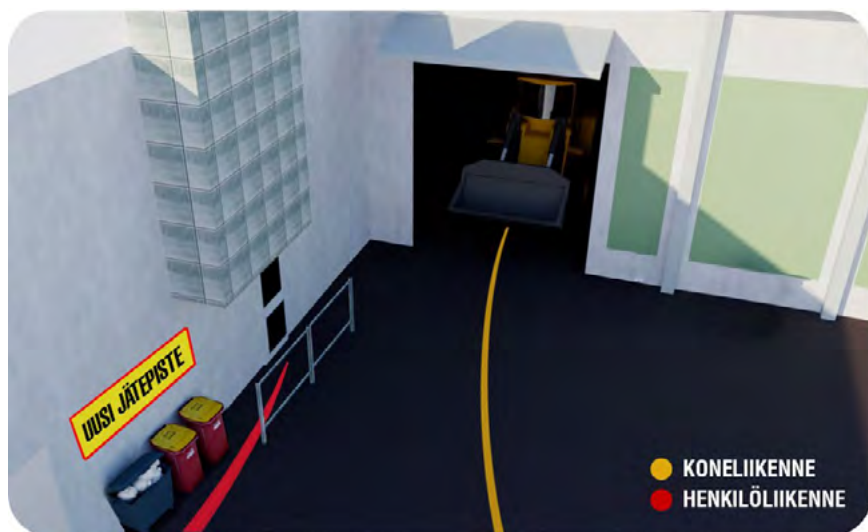
Kuva 13. Kuvassa havainnollistettu henkilö ja koneliikenteen kulkureittejä roska-astioiden ja suojaverkkojen uudelleen järjestelyn jälkeen
