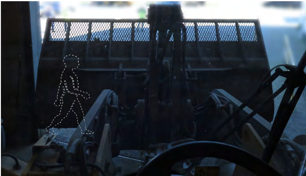
Kuva 4. Kuvassa havainnollistettu pyöräkuormaajan kauhan aiheuttamaa katvealuetta lähellä olevaan henkilöön.
