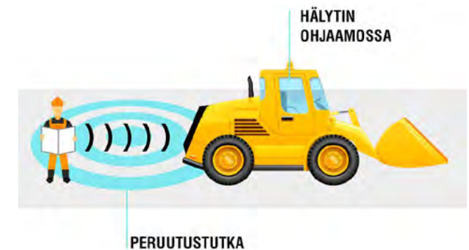
Kuva 8. Havainnollistettu peruutustutkan toimintaperiaatetta. Törmäysriskin pienentämiseksi henkilöllä voi olla yllään esim. RFID-tunnistimilla varustettu huomioliivi tai kypärä. Ajoneuvon ohjaamossa oleva vastaanotin hälyttää, kun henkilö joutuu tutkan vaikutusalueelle. RFID-tunnisteita käyttämällä vältetään tutkan katvealueilta, joita syntyy joissain peruutustutkamalleissa.
