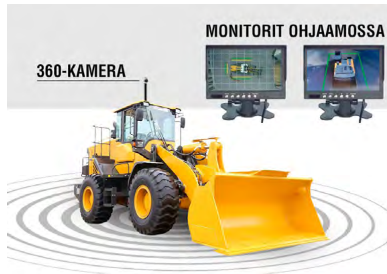
Kuva 10. Havainnollistettu pyöräkuormaajaan asennettavaa 360 kameraa. Kameran avulla ohjaamon monitoreista on mahdollista nähdä esim. lähellä kauhaa olevat objektit
